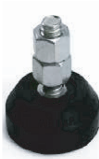
Antivibratório de Borracha com parafuso e porcas de fixação. Borracha: Ø25mm x 15mm Parafuso M6 x 23mm
